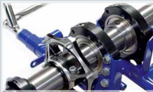
Geänderte Hinterachsaufnahme und Lagerschalen verbessern die Beschleunigung aus der Kurve
