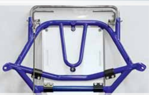
Kart FIA1SE mit überarbeiteter Grundgeometrie und zweitem vorderen Stabilisator.
